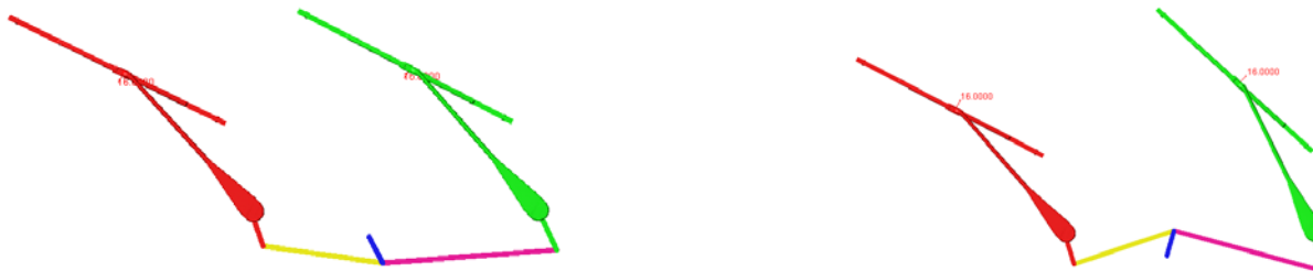
Fig. 2. Mișcarea ascendentă, respectiv descendentă a lamelelor ștergătoare.
